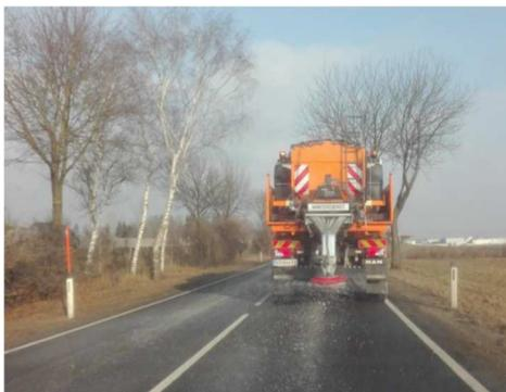
Im NÖ Straßendienst wird seit Jahrzehnten grundsätzlich Feuchtsalzstreuung durchgeführt. Der besondere Vorteil bei dieser Streutechnik liegt darin, dass einerseits eine bessere Haftung und gleichmäßigere Verteilung der Streumittel auf der Fahrbahn erreicht wird, und andererseits eine schnellere Tauwirkung einsetzt.
